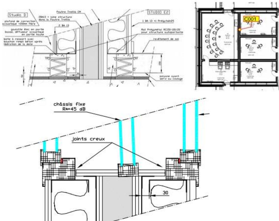
Schéma de principe réalisé en réunion de chantier en collaboration avec l'entreprise pour la mise en œuvre de deux chapes flottantes.
