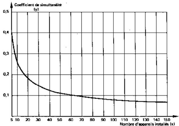
Coefficient de simultanéité en fonction du nombre d'appareils installés
