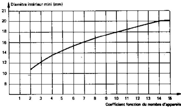
Diamètre intérieur minimal d'alimentation en fonction du nombre d'appareils
