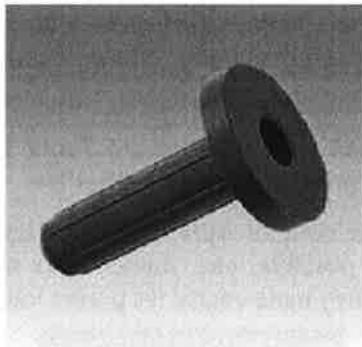
Les bâtis autoportants, qu'ils soient pour les urinoirs, à chasse réservoir ou à chasse directe seront désolidarisés du sol par un matériau antivibratile et fixés à l'aide de chevilles antivibratiles à collerette.
