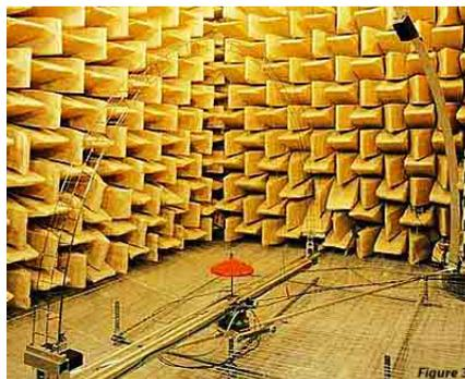
**Figure 12 :** Vue du mode opératoire utilisé pour mesurer le coefficient de diffusion
