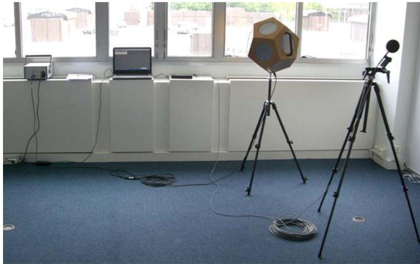
**Figure 37 :** *Photo du matériel de mesure (Amplificateur + Carte d'Acquisition + Source + Microphone)*
