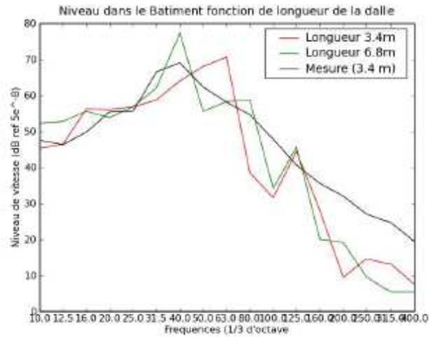
**Figure 5.6 : Niveaux vibratoires sur dalle RdC recalculés à partir des fonctions de transfert sol /bâtiment ; comparaison de 2 portées de dalle.**
