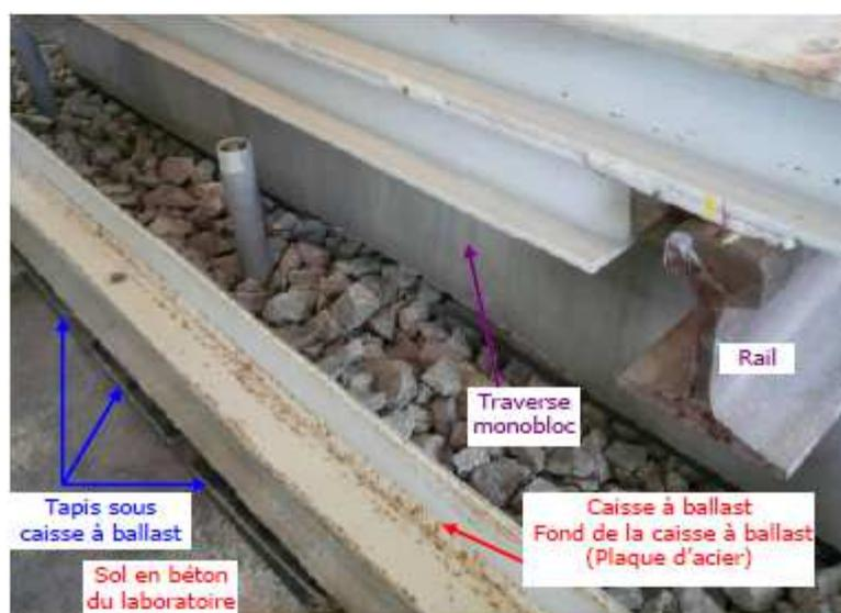
**Figure 2.2 : Détail du système expérimental – Tapis sous caisse à ballast.**
