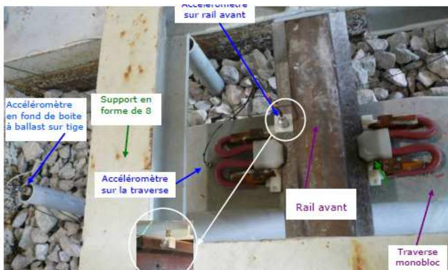
Figure 2.4 : Détail du système expérimental – Montage des accéléromètres au niveau du rail avant.
