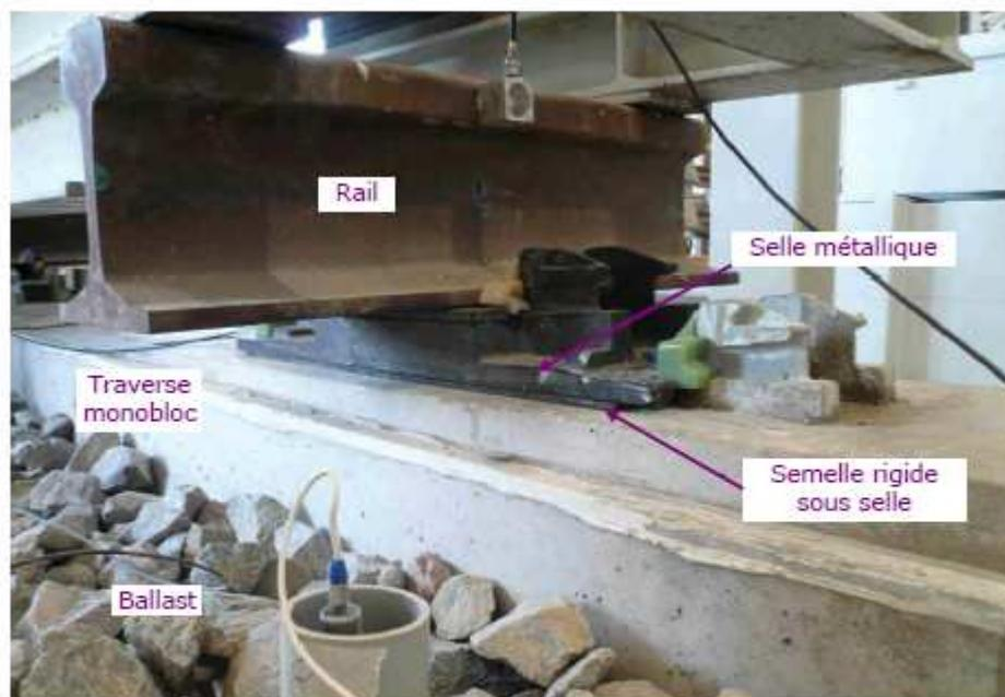
Figure 4.1 : Système de référence pour l'évaluation de la perte par insertion – Semelle sous selle rigide.
