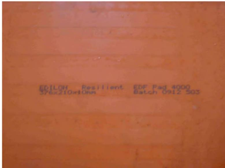
Figure 6.4 : Photographie de la sous-couche résiliente EDILON 4000.
