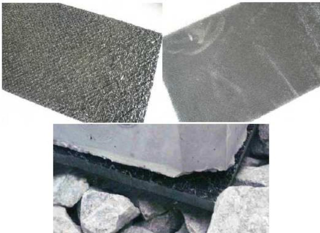
Figure 6.1 : Photographie de la sous-couche résiliente SL1510 G.
