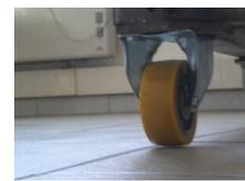
*Efficacité vibratoire de la roue 80 sh à l'émission (dalle magasin) et en réception (dalle logement)*
