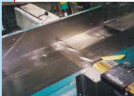
Fig. 12 - Vue d'une dégauchisseuse munie de couteaux hélicoïdaux
