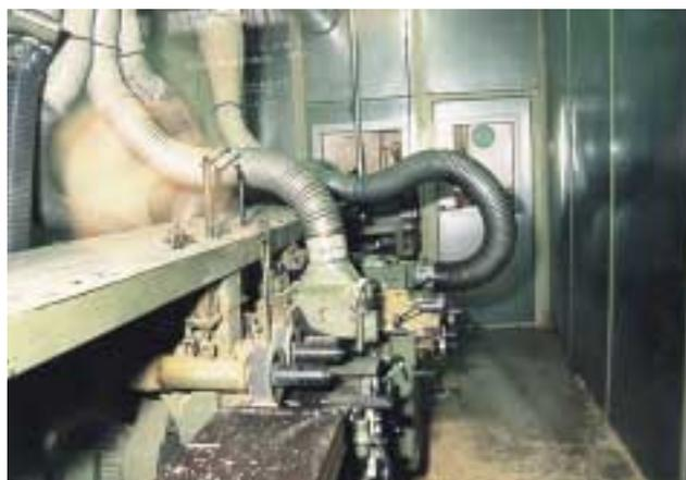
Fig. 11 - Accès facile aux différents réglages de la machine dans la cabine d'insonorisation
