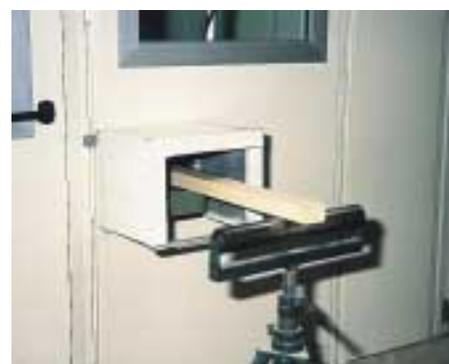
Fig. 10 - Tunnel absorbant sur orifice d'alimentation d'une machine
