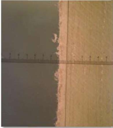
**Figure 2a : Mesure de la couche de protection avec une loupe X10 (Alphaliner 1800)**
